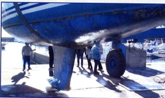
diamante. Di norma non si evidenziano rotture sugli spigoli dovuti a vuoti di laminazione, né ragnatele. Segno di un'accurata ed esperta lavorazione della vetroresina.
